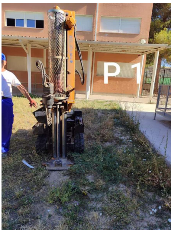
Figura N° 5.- Trabajos para la realización de la penetración dinámica, tipo DPSH, referida como P-01.
