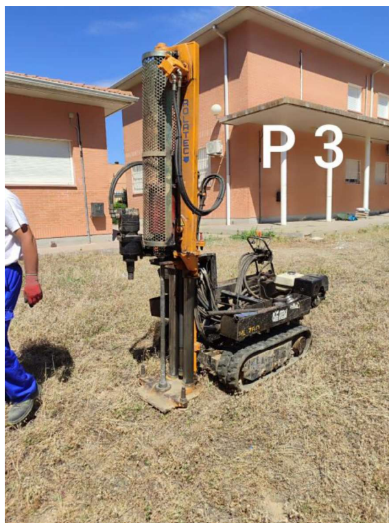
Figura Nº 7.- Trabajos para la realización de la penetración dinámica, tipo DPSH, referida como P-03.
