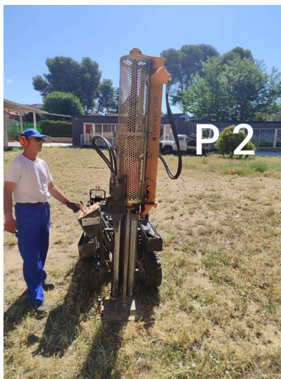
Figura Nº 6.- Trabajos para la realización de la penetración dinámica, tipo DPSH, referida como P-02.
